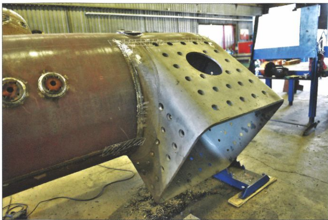
Detailfoto van de overgang tussen de ronde ketel en de buitenvuurkist, 7 juni 2018. De twee flenzen links zijn voor de persleidingen van het voedingswater uit de injecteurs.
