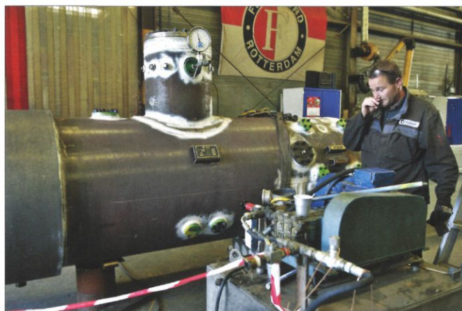
De ketel van de 37 tijdens de waterproef, met een medewerker van de fabriek die het verloop in de gaten houdt.
