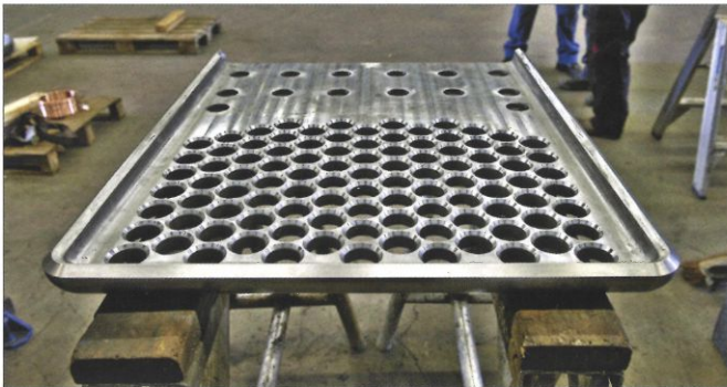
De achterpijpenplaat, 25 mm dik en met 100 vlampijpgaten, is een mooi stuk werk. De schuine kanten van die plaat vormen met de schuine kanten van de aangrenzende ketelplaten een V-vorm, zodat een diepe las kan worden gemaakt.
