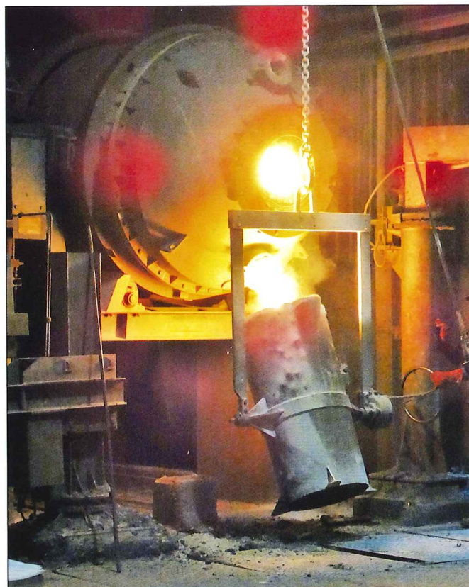
Het vloeibare gietijzer stroomt uit de grote smeltoven de mengbeker in.
