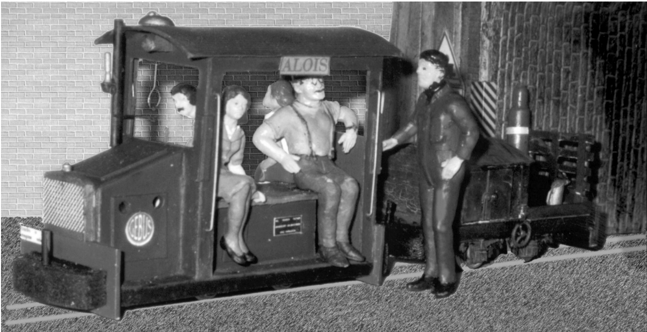
Triebwagen "Alois" im Einsatz mit einem Gerätewagen der Zeche Ibbenbüren. Der Triebwagen ist tatsächlich aus Pappe, nur die Zurüstteile wie Glocke, Scheinwerfer, Auspuff, Pfeife, Kühler und Puffer sind aus Kunststoff.
