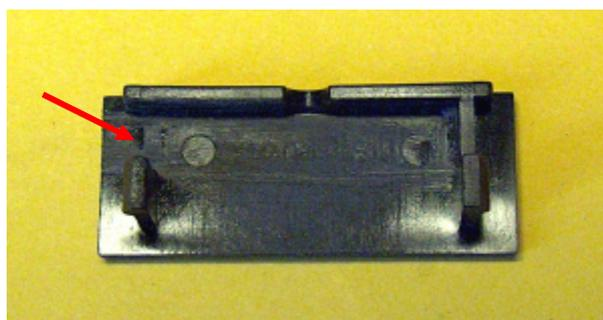
Linksseitig wurde der Steg zur Rastnase für den Kabelaustritt entfernt (Feilen oder Fräsen).
