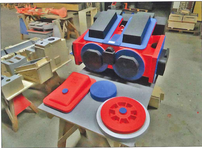
Het houten gietmodel van het nieuwe cilinderblok van de 37. Op de voorgrond de losse gietmodellen van het schuifdeksel (links), de zuiger (midden) en de cilinderdeksels (rechts). Geheel links liggen de negen losse gietkernen.
